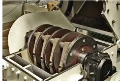
Broyage par percussion avec un rotor muni de marteaux fixes ou mobiles et un stator muni d'une grille assurant la granulométrie.
