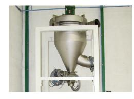
Classificateur dynamique composé d'un rotor de classificiation à vitesse variable, d'un air de rinçage et d'une goulotte de décharge des refus.
