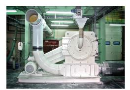
Broyeur universel à axe horizontal avec possibilité d'adapter différents outils de broyage interne : marteaux, pales, broches... permettant de traiter différents produits avec différentes granulométries dans un même broyeur.
