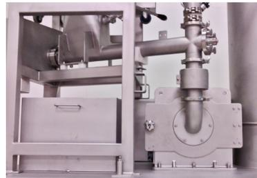
Broyeurs spécialement étudiés pour permettre un nettoyage aisé et éliminer tout risque de rétention de produit pouvant provoquer une contamination. Destinés aux applications devant répondre aux standards de qualité GMP/BPF.
